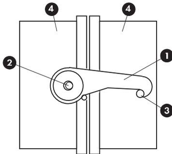
Una vez enganchados los paneles, el agujero de acceso al cuadrado de abertura-cierre se cubre a presión con un tapón de plástico. El apriete del gancho tiene dos posiciones: la primera hace de arrastre y posicionamiento, y la segunda de apriete.
