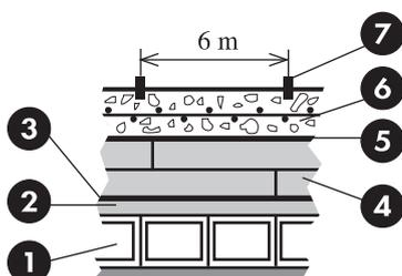
6- Hormigón armado de resistencia característica 200 kg/cm<sup>2</sup>, formando una capa de 120 mm de espesor como mínimo. La armadura será de malla electrosoldada formada por redondos de 5 mm. de diámetro cada 150 mm.
