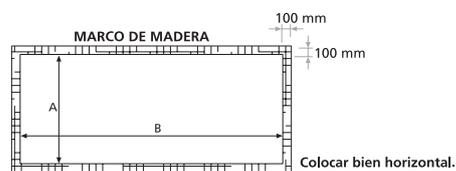
Dimensiones interiores del marco en madera (caso de montaje en muro).
