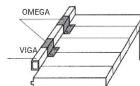
En las juntas transversales de unión se apoyarán o se colgarán los paneles en función de las características del local donde se instale la cámara.
