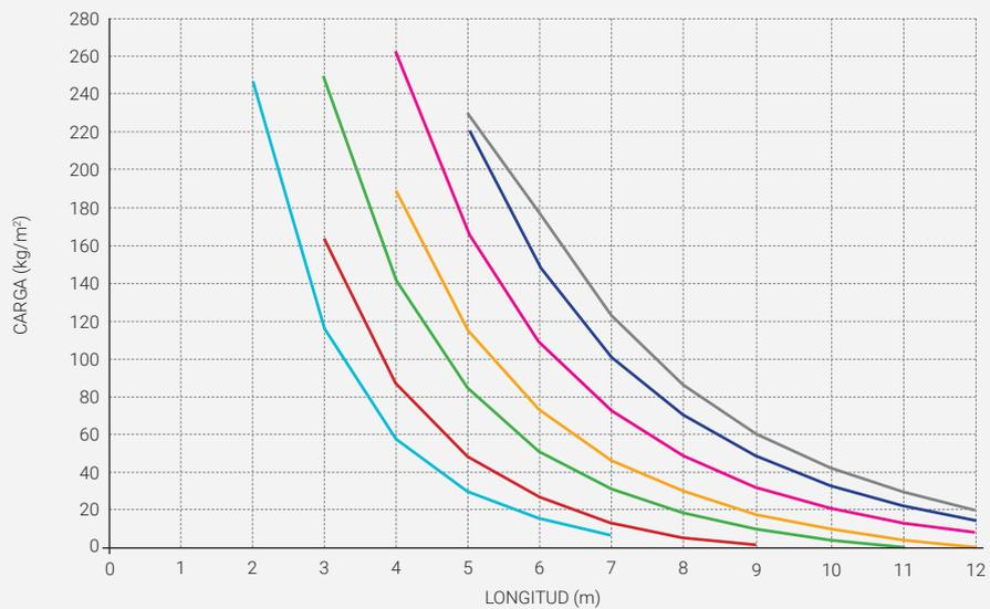
Cargas admisibles para panel según el espesor, flecha  $L/200$  y norma NBE 95. El coeficiente de seguridad es de 1,7. Por tanto y según la norma, las combinaciones de cargas NO deben ser mayoradas.
