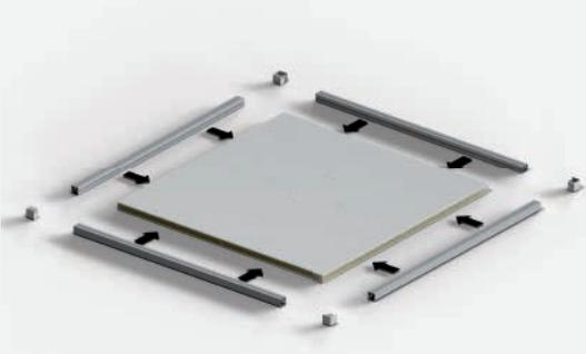
En el caso de que la cámara sea sin suelo el apoyo del vertical será según figura A. El suelo del perímetro de la cámara debe estar totalmente nivelado en una anchura de E+150 mm.
